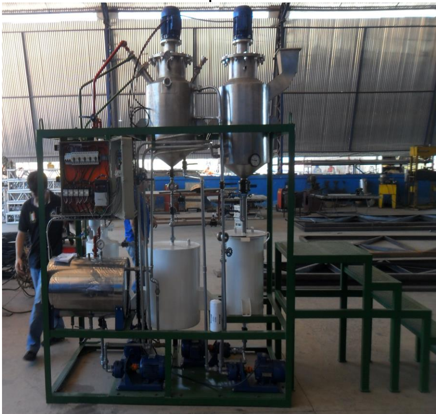
Figura 6. Unidade Contínua destinada a extração de óleo de vísceras de peixes
